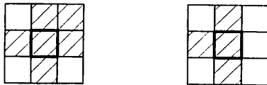
初期領域の種になる画素 初期領域の種にならない画素
